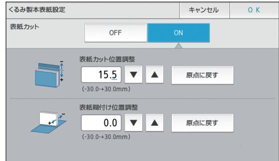
[表紙カット位置調整] は、[▲]をタッチするたびに0.1mmずつカット位置が背表紙の方向に移動し、カット部分が増えます。[▼]をタッチするたびに0.1mmずつ背表紙から離れ、カット部分が減ります。
